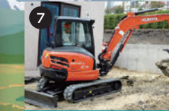
7 工程机械(小型挖掘机) 进行土木施工等。特别适合用于街道等狭窄的场所。
