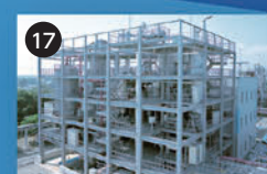
17 下水污泥焚烧炉 对下水处理时产生的污泥进行焚烧和熔融处理的成套设备。
