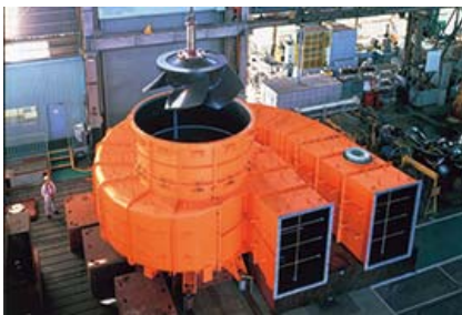
水泵 压送水，用于给排水管道，雨水排水等。
