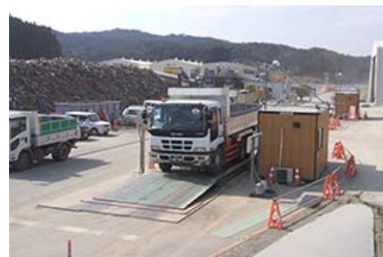
卡车称重仪（为卡车装载来的瓦砾进行测重）
