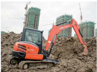
7 工程机械（小型挖掘机） 进行土木施工等。特别适合于用于街道等狭窄的场所。
