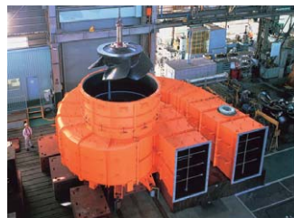
12 水泵 压送水，用于给排水管道，雨水排水等。
