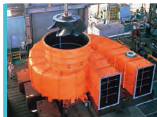
水泵 压送水，用于给排水管道，雨水排水等。
