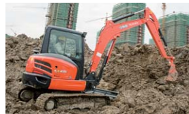
7 工程机械(小型挖掘机) 进行土木施工等。特别适合用于街道等狭窄的场所。
