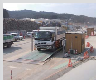
卡车称重仪 为卡车装载的瓦砾进行称重。
