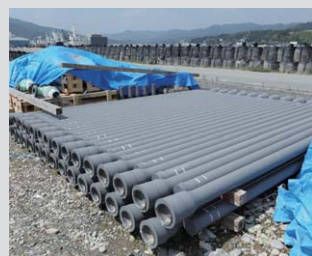
铁管 用于给排水管道、煤气管道等生活基础设施的修复和重建。
