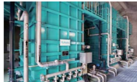
14 陶瓷膜 对河川及水源地的水进行高度净化处理,使其成为饮用水。
