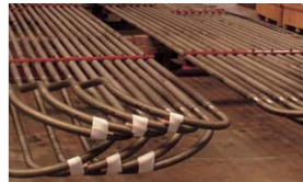
20 铸钢 用于乙烯精炼等石油化工成套设备。
