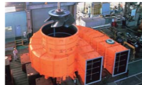
12 水泵 压送水,用于给排水管道,雨水排水等。
