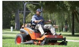
5 乘坐式剪草机 在一般家庭庭院,公司周边,公园等进行草地修剪。
