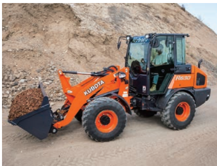
轮式装载机 主要在施工现场或农场用于搬运和装载作业。
