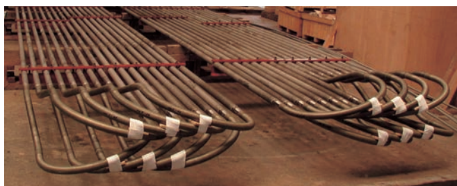
裂化蛇形管（分解管） 用于石油化工成套设备的乙烯精炼等。
