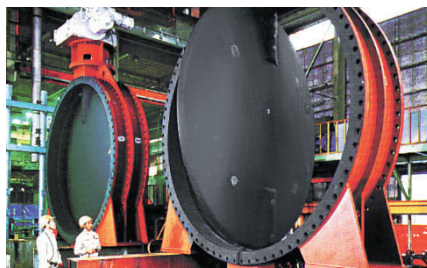
阀门 控制各种水和气体，用于给排水道和农林、雨水市场等。
