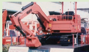
后来的久保田小型挖掘机系列的雏形 ——完全旋转式小型液压挖掘机
