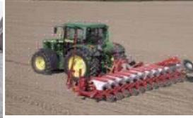
Рядовая сеялка точного высева
