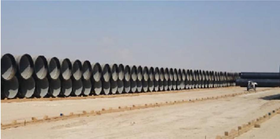
用作送水管的球墨铸铁管
