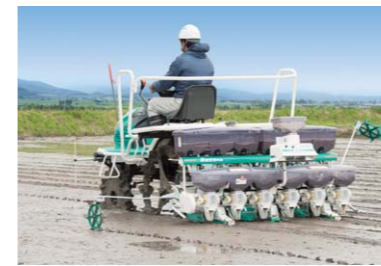
覆铁粉直接播种专用机 6条铁粉播种机 (WELSTAR WORLD WP60D-TC)
